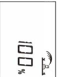
Le programmeur possède une fonction (appelée Water Budget ou ajustement automatique) qui permet de moduler l'apport d'eau sur les 3 programmes de 0 à 200%, et ce sans avoir à modifier les temps d'arrosage de chaque station.
