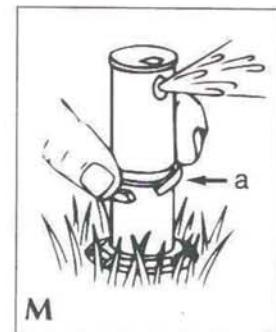
**F** Le réglage du secteur s'effectue sur un appareil en fonctionnement et ce, quelque soit la position et le sens du jet. R-50 a en mémoire un secteur existant. L'angle que vous allez régler viendra s'ajouter à ce secteur existant. NB : lorsque l'on tourne la tête de l'arroseur tout en l'enfonçant, un son caractéristique indique que le réglage en cours est correctement effectué.
